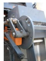
Al fine di limitare al minimo la probabilità di contatto di parti del corpo dei lavoratori con gli organi di spandimento in moto (disco e palette), è necessario che la coda dello spargisale sia dotata di dispositivo di interblocco che arresti il movimento degli organi di alimentazione (coclea, nastro, ecc.) e di distribuzione (disco con palette) quando viene sollevata e che non consenta l'avvio di tali organi fintanto che la coda non risulti completamente abbassata.
