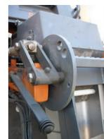
nell'eventuale regolazione della coda di spandimento assicurarsi, al termine dell'operazione del corretto serraggio della stessa.
