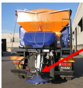
Il sistema di spandimento, composto da un tubo convogliatore e da un disco distributore dotato di palette spargisale, è denominato "coda di spandimento". La coda di spandimento è regolabile in altezza ed è dotata di un dispositivo per lo spandimento simmetrico e asimmetrico.
