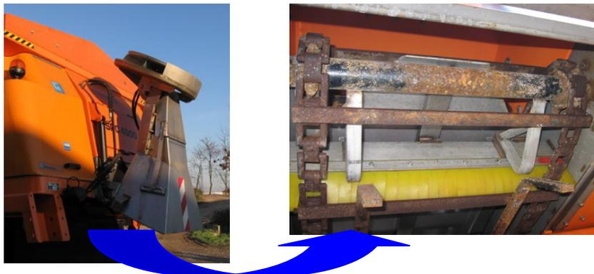
Lo spargisale in base alla sua tipologia costruttiva è dotato di organi per la trasmissione del moto che ai fini della sicurezza possono essere pericolosi se non sono segregati da ripari o da parti strutturali della macchina stessa.
