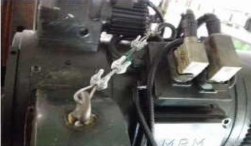
*Particolari dell'applicazione dei cordini di fissaggio sui motori delle presse.*
