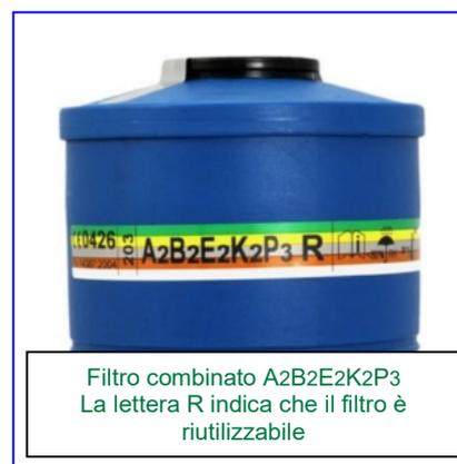
La sigla identificativa è costituita in sequenza da: lettera identificativa del tipo di filtro per gas/vapori, classe, P, efficienze del filtro per particelle. Es.: A2 P3 indica un filtro combinato, adatto per gas/vapori organici con p.e. 65 °C in classe 2 e per particelle in classe 3.
